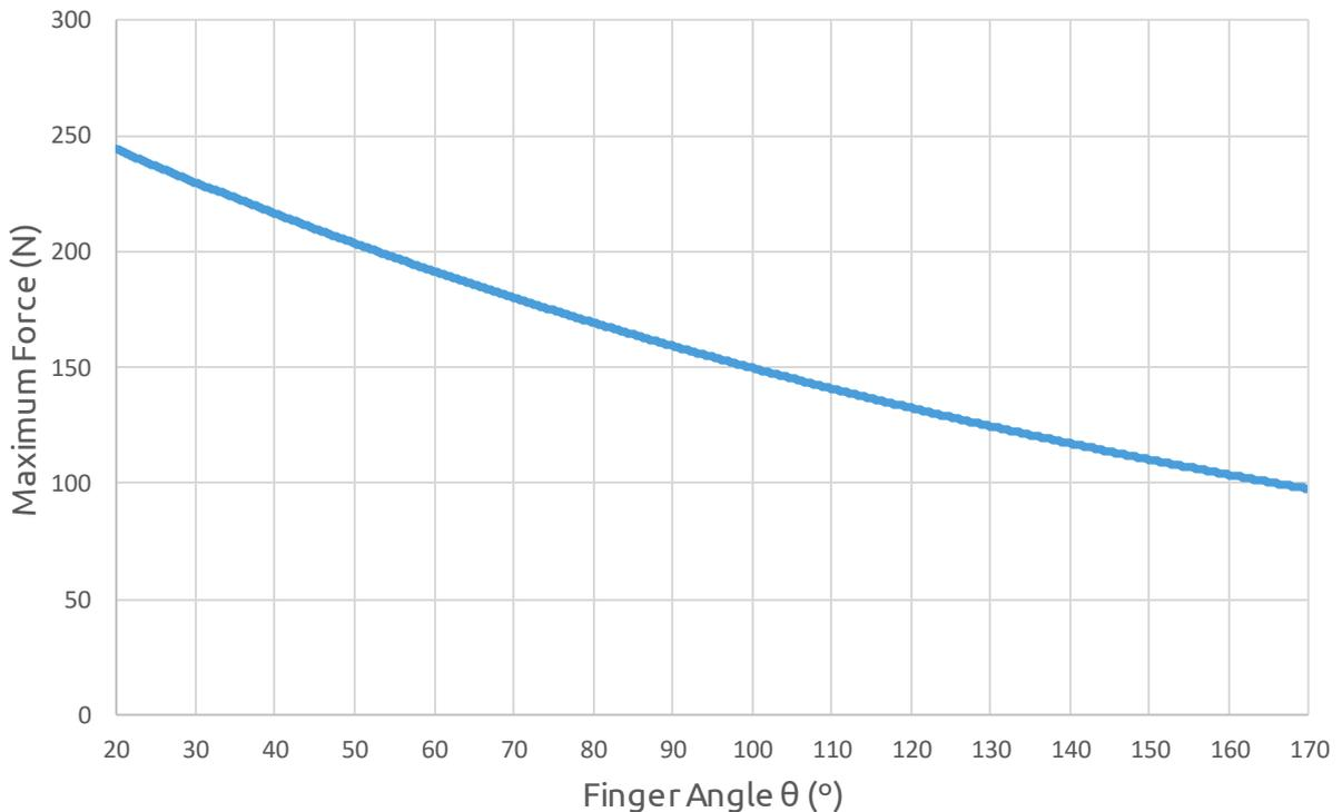
Gráfico elaborado utilizando medidas com corrente de 1 A, pontas dos dedos de silicone e uma peça de trabalho de metal.
