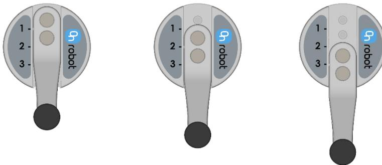
交付的抓指长度为 49 mm (下图中的长度)。如果需要定制抓指，可以根据下面显示的尺寸 (mm)[英寸]使其匹配 Gripper：所需的螺丝为 M4x8mm (使用 3Nm 拧紧扭矩)：
