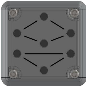
La plaque d'adaptateur compte 7 trous pour utiliser les fixations avec des coupes à vide ou des obturateurs selon les besoins. Elle porte aussi des lignes montrant les orifices communiquant entre eux. Cela est utile lorsque les canaux A et B sont utilisés indépendamment pour la dépression.
