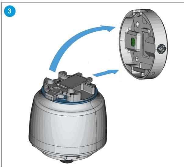
Il est fortement recommandé d'installer l'embase SG sur le robot avant d'installer l'outil SG. Assurez-vous que l'embase SG est en position initiale ou initialisée.
