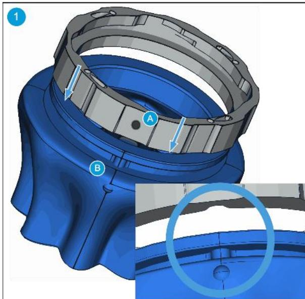
Tournez la bague de manière à orienter le repère **(A)** vers vous. Alignez le point de l'outil SG **(B)** avec le repère **(A)**. Ajustez-les ensemble et montez la bague sur l'outil SG.
