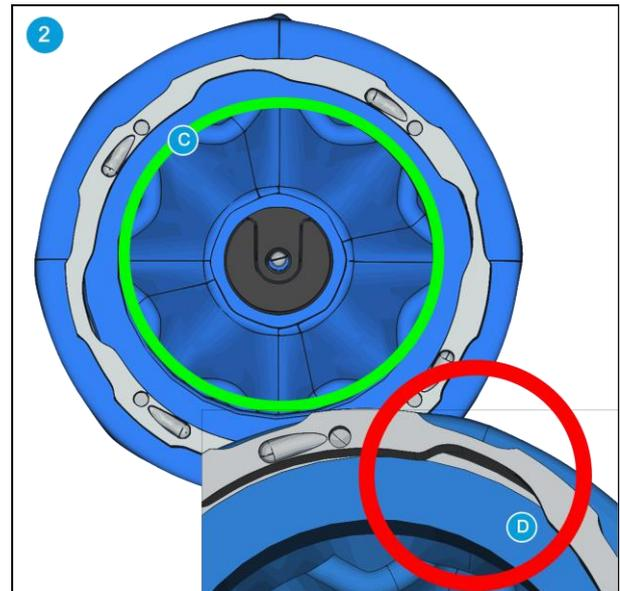
Poussez l'outil SG vers le haut contre la bague pour qu'il s'ajuste parfaitement **(C)**. Veillez à ce qu'il n'y ait aucun espace entre l'outil SG et la bague **(D)**.
