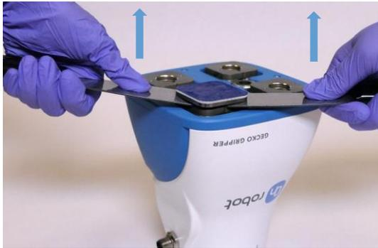
**Étape 3 :** Pour installer de nouveaux coussinets de rechange, alignez l'encoche du coussinet avec la languette dans le trou de montage. Poussez le coussinet dans le préhenseur jusqu'à ce qu'il n'y ait plus d'espace entre la plaque argentée brillante du coussinet et la plaque de support.
