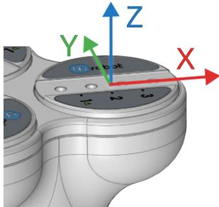
Das maximal zulässige Drehmoment, das in den Bereichen X und Y auf das Greiferfingerende ausgeübt wird, beträgt 8 Nm.
