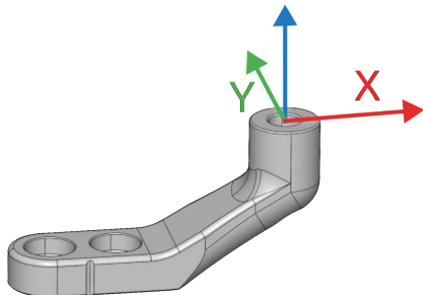
Die Bilder oben zeigen das Koordinatensystem, aus dem die maximal zulässigen Drehmomente berechnet werden.
