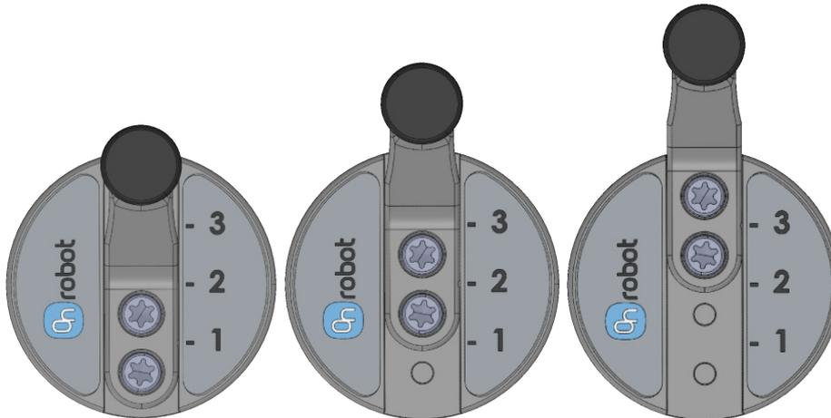
Die gelieferte Fingerlänge beträgt 42,6 mm (L in der Zeichnung unten). Wenn spezielle Finger erforderlich sind, können diese gemäß den unten angegebenen Abmessungen (mm) [Zoll] an den Greifer angepasst werden. Die benötigten Schrauben sind M5x8 mm groß (verwenden Sie ein Anzugsdrehmoment von 2,5 Nm):
