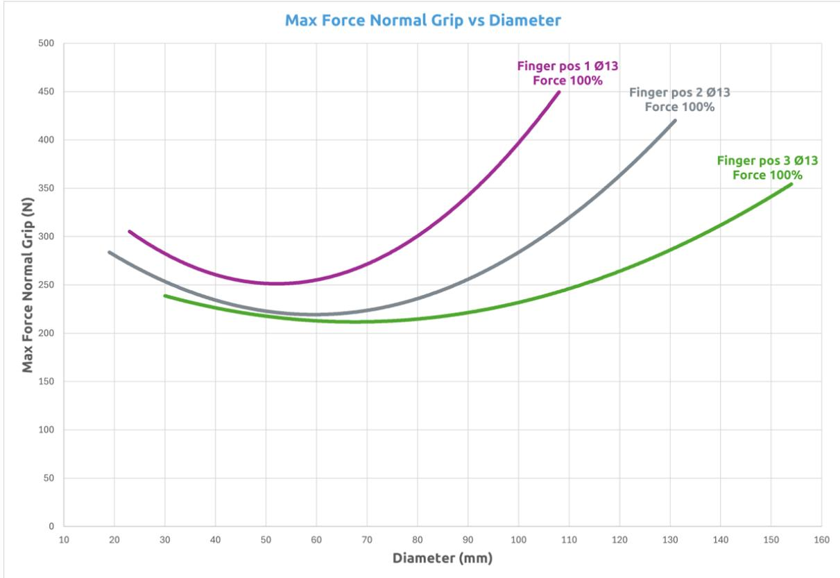
下のグラフは、フレキシブル把持機能を使用した場合に、フィンガーの位置に応じて特定の直径に対してどのような力が得られるかを示しています。最大値は 300N で、いかなる場合でもこの値を超えません。このグラフは、標準フィンガーの 3 つの位置すべてでの測定値と、 $\text{\O}13$  mm のスチール製フィンガーティップ、金属製のワークピースを使用してプロットされています。
