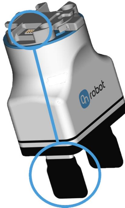
Debe tenerse en cuenta la presencia del sensor de fuerza cuando se alinee la pieza de trabajo con las puntas de la pinza o se recoja la pieza de trabajo de lado, puesto que la gravedad puede afectar a la medición de fuerza.
