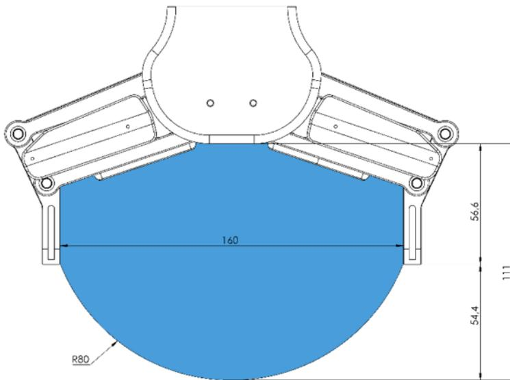
La préhension sur de longs objets peut accidentellement déclencher les interrupteurs de sécurité. La hauteur maximale de pièce (calculée à partir de l'extrémité des bouts de doigts) dépend de la largeur de préhension ( $w$ ). La limite de hauteur ( $h$ ) est fournie ci-dessous pour les différentes valeurs de largeur :
