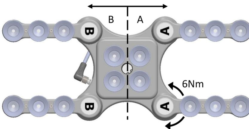
Quand les quatre bras sont ajustés aux angles choisis, il est conseillé d'ajouter les autocollants fléchés qui les accompagnent. Cela permet de facilement réaligner les pièces de travail et d'en changer.
