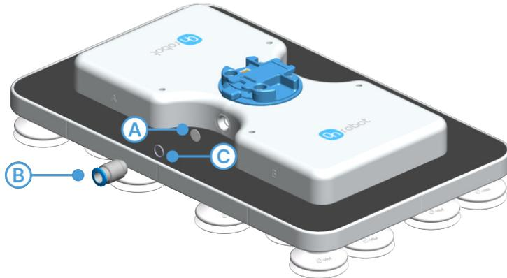
Pour retirer le **filtre d'entrée (A)**, utilisez une clé hexagonale de 7 mm pour dévisser et retirer le **raccord (B)**, puis retirez soigneusement le **joint torique (C)** à l'aide d'un petit tournevis. Placez le préhenseur sur le côté avec le trou du filtre orienté vers le bas, permettant au filtre de glisser naturellement par gravité.
