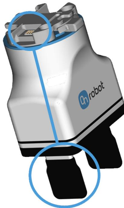
Tenere presente la presenza del sensore di forza quando il pezzo viene allineato utilizzando le dita della pinza o quando il pezzo viene prelevato lateralmente, poiché la gravità può influenzare la misurazione della forza.
