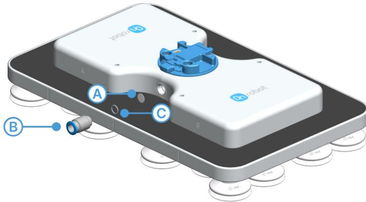
Per rimuovere il filtro di ingresso **(A)**, utilizzare una chiave esagonale da 7 mm per svitare e rimuovere il raccordo **(B)**, quindi rimuovere con attenzione l'o-ring **(C)** con un piccolo cacciavite. Posizionare la pinza su un lato con il foro del filtro rivolto verso il basso, consentendo al filtro di scivolare fuori naturalmente per gravità.
