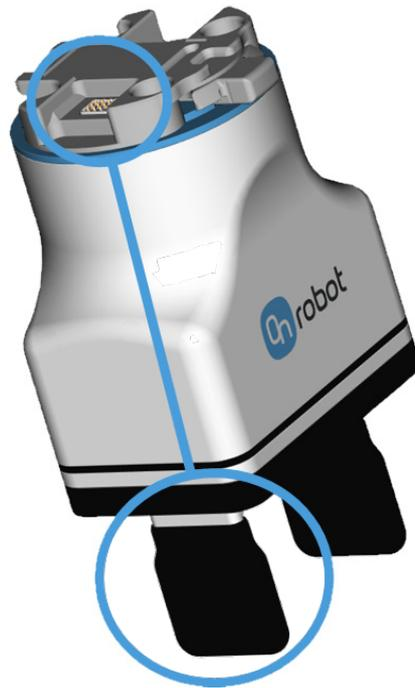
在使用夹爪的抓指对准工件时或从侧面拾取工件时，考虑存在力传感器，因为重力会影响作用力测量。
